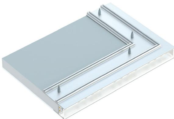
Ejemplo de montaje de perfil de pared APA12 en placa de yeso con grosor de 12,5 mm bajo un ángulo recto.
