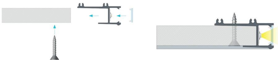
Instrucción de montaje de perfil dedicado para la instalación en la pared APA 12/16 con difusor BASIC.
