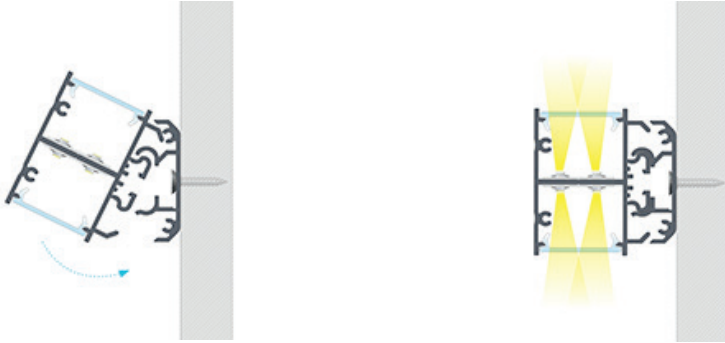
Instrucción de montaje de perfil DOPIO con difusor DOUBLE usando el tornillo de montaje y perfil de montaje TALIA M1.
