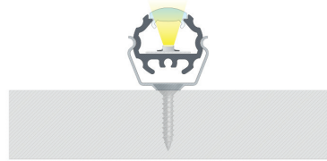
El resultado final de instalación de perfil redondo MICO con difusor SLIM LENS 15 y grapa de sujeción MICO de metal.
