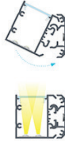
Instrucción de montaje de perfil UNICO con difusor DOUBLE usando el tornillo de montaje y perfil de montaje TALIA M1, y resultado final.
